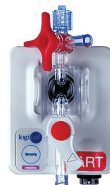
Płytki (przetwornik) MX960 z kopułką MX960SCFA
