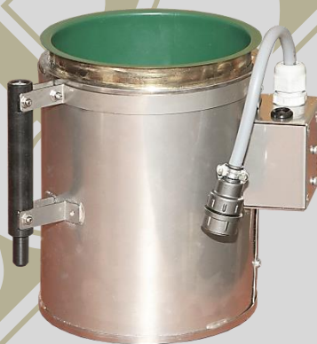
Stacja parafinująca . Widoczny uchwyt, przyłącze , teflonowane wnętrze naczynia
