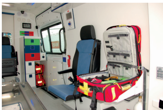
Mocowanie plecaka medycznego pełniące równocześnie funkcję półki pozwalającej na „awaryjne” korzystanie z plecaka we wnętrzu karetki.
